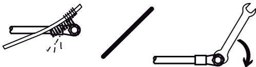
Verificar e limpar conexões dos cabos de solda
