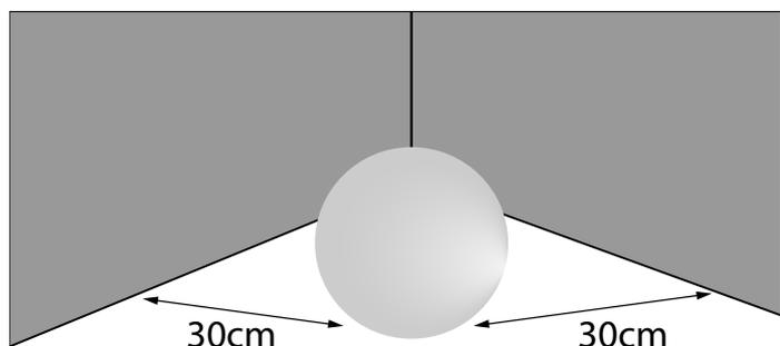
A máquina deve ser posicionada de forma que nada obstrua as entradas e saídas de ar/resfriamento.
